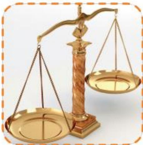
Hay dos clases de instrumentos para determinar la masa: la balanza común (o balanza de platos) que determina la masa porque la acción de la gravedad sobre el objeto que ese está pesando se anula por ser igual a la que sufre la pesa empleada (en otro platillo). La balanza de resortes, en cambio determina el peso debido a que el resorte responde a la acción de la gravedad sobre la masa del cuerpo que se está pesando. La balanza de resortes, por consiguiente, da el peso en newton.
